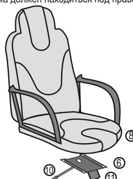
6. Сиденье установите отверстием в металлической площадке на газпатрон.
